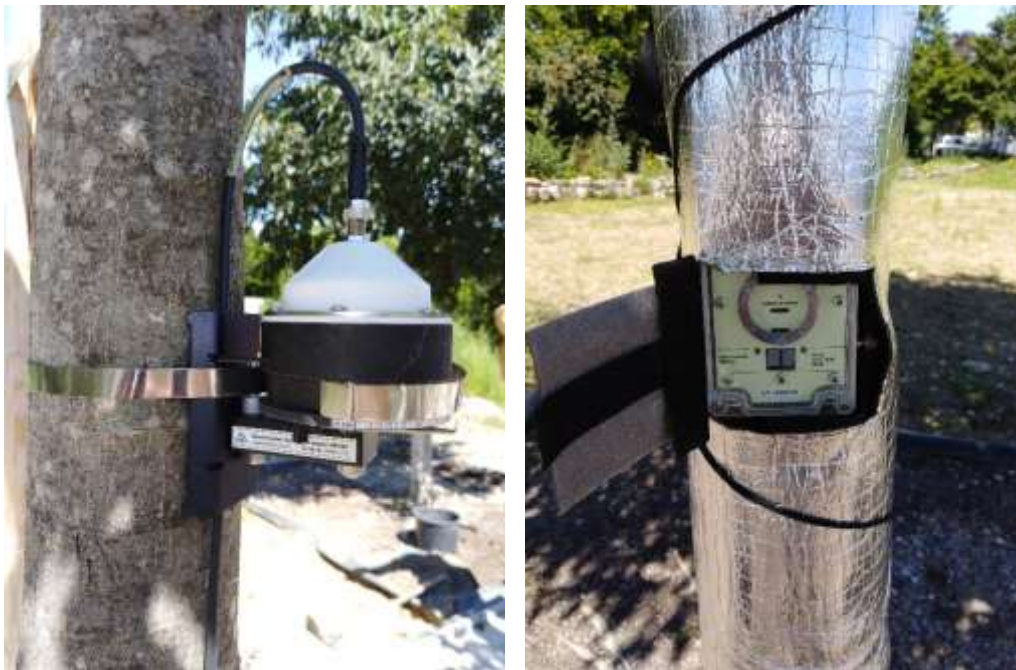
Abb. 12 © Johannes Selinger, linkes Bild: Dendrometer (Messung d. Stammumfangs); rechtes Bild: Saftstrommessung
